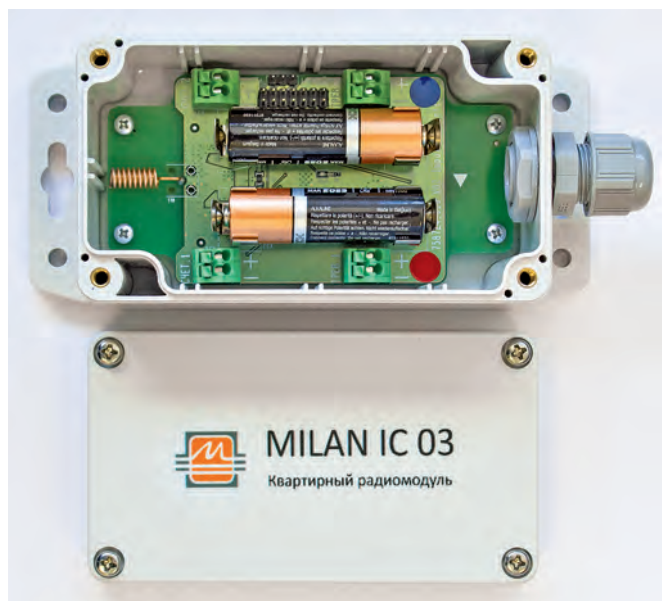
Рис.2. Внешний вид квартирного радиомодуля со снятой крышкой
